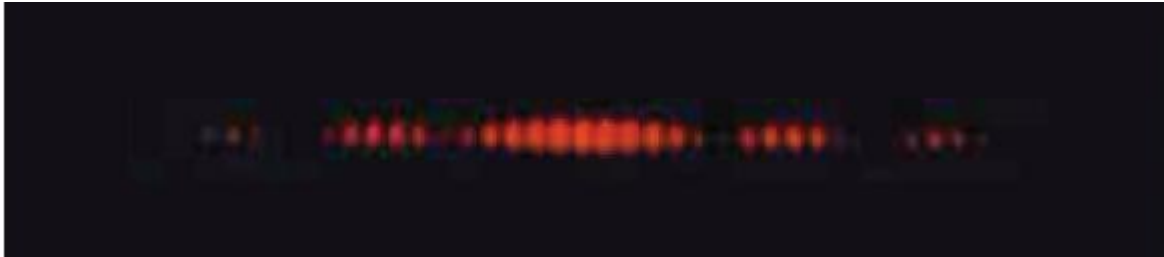
Figure 8.1.5. Des franges d'interférence sont représentées pour la lumière passant par deux fentes étroites et rapprochées. L'espacement des franges dépend de la longueur d'onde, les franges étant plus rapprochées pour la lumière bleue de courte longueur d'onde. (crédit : PASCO)
