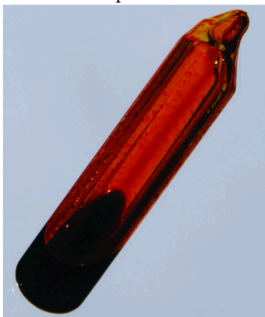
Figure 4.1.4. Un équilibre est illustré entre le brome liquide, \text{Br}_2(l) , le liquide sombre, et la vapeur de brome, \text{Br}_2(g) , le gaz brun-rougeâtre. Comme le récipient est scellé, la vapeur de brome ne peut pas s'échapper et l'équilibre est maintenu. (crédit : http://images-of-elements.com/bromine.php )
