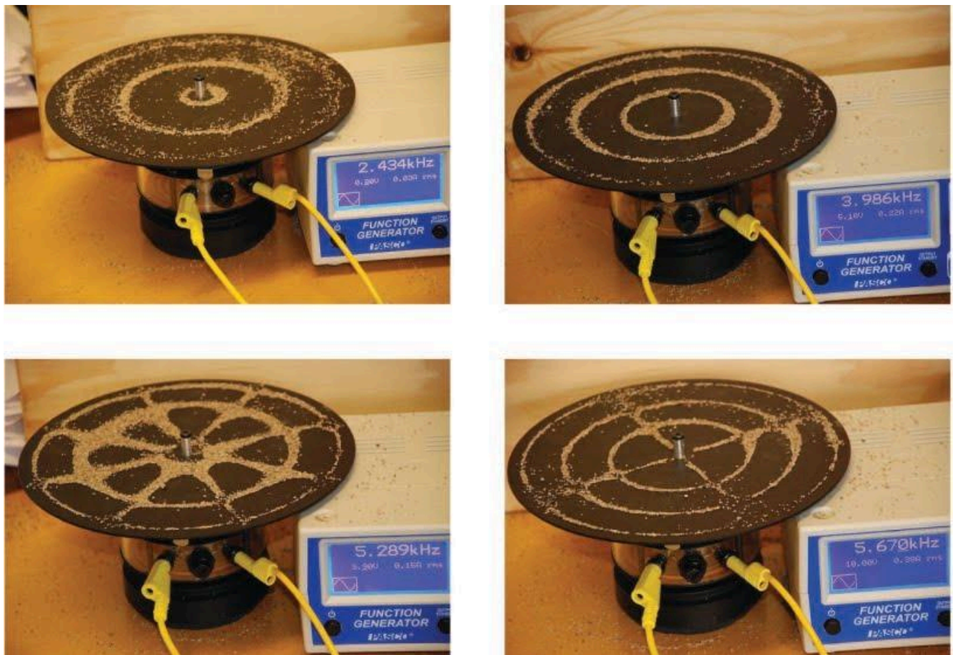
Figure 8.1.7. Des ondes stationnaires bidimensionnelles peuvent être visualisées sur une surface vibrante. La surface a été saupoudrée d'une poudre qui s'accumule près des lignes nodales. Deux types de nœuds sont visibles : les nœuds radiaux (cercles) et les nœuds angulaires (rayons).
