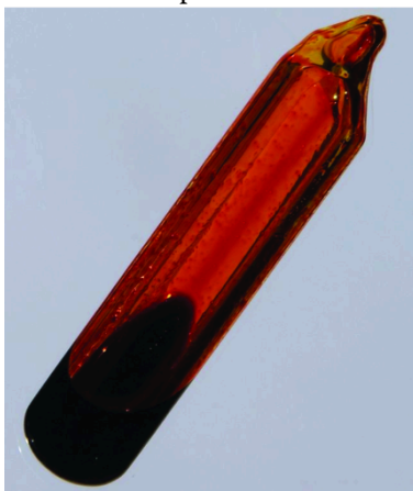
Figure 4.1.4. Un équilibre est illustré entre le brome liquide, \text{Br}_2(l) , le liquide sombre, et la vapeur de brome, \text{Br}_2(g) , le gaz brun-rougeâtre. Comme le récipient est scellé, la vapeur de brome ne peut pas s'échapper et l'équilibre est maintenu. (crédit : http://images-of-elements.com/bromine.php )
