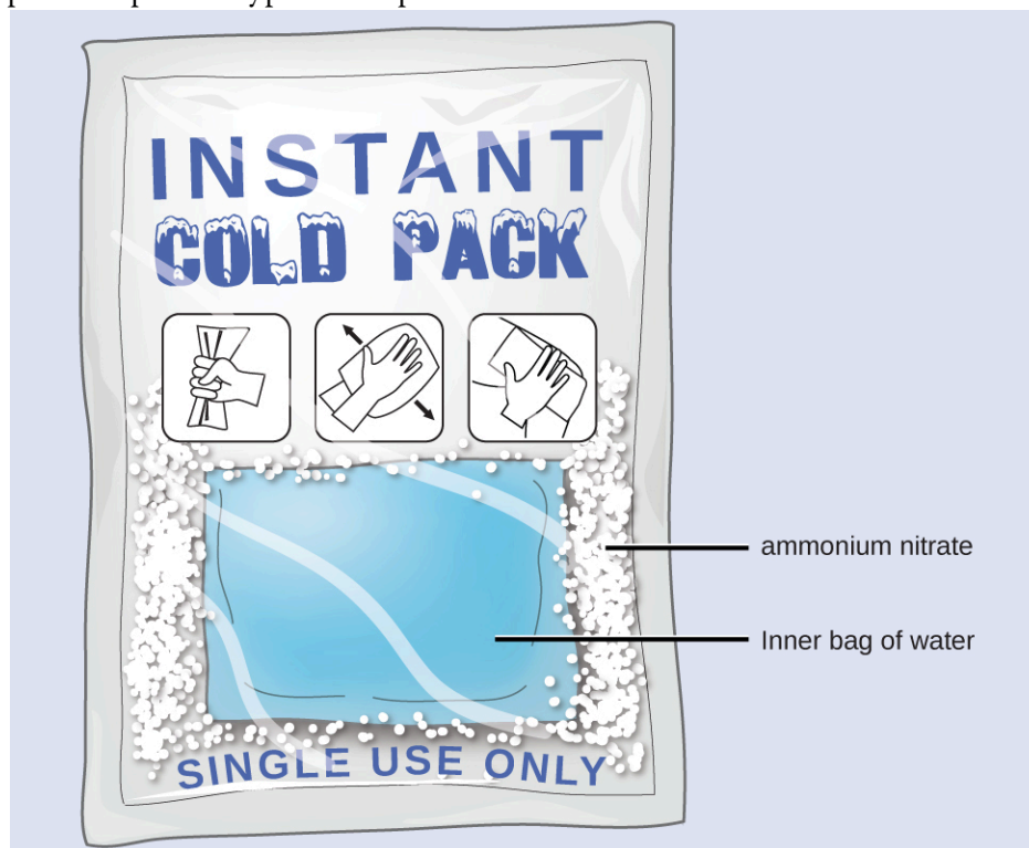
Figure 3.5.6. Une poche froide instantanée se compose d'un sac contenant du nitrate
