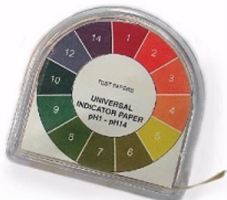
Figure 6.3.4. Papier pH. Le papier pH contient un ensemble d'indicateurs qui changent de couleur à différentes valeurs de pH. Le pH approximatif d'une solution peut être déterminé en trempant simplement une bande de papier dans la solution et en comparant la couleur aux normes fournies.
