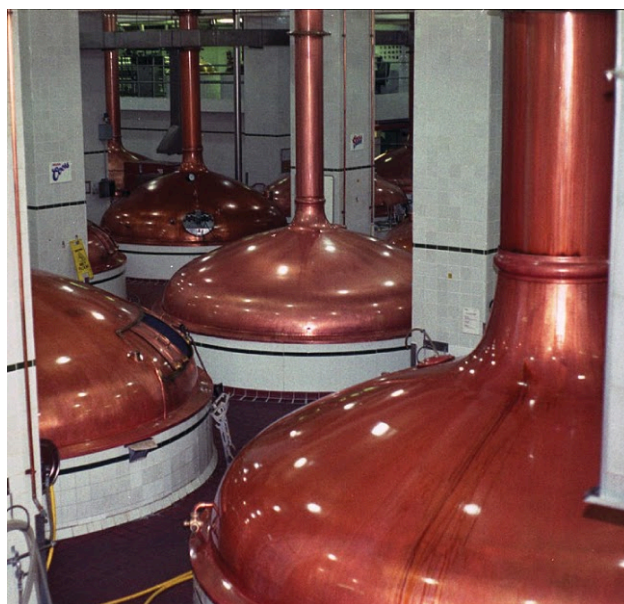
Figure 1.2.7. Un oxyde de carbone est éliminé de ces cuves de fermentation par les gros tuyaux en cuivre situés au sommet. (crédit : “Dual Freq“/Wikimedia Commons)
