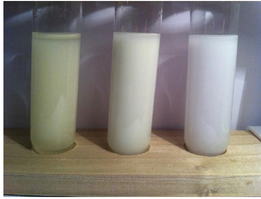
Figure 1.4.8. Les trois précipités communs d'halogénure d'argent : AgI, AgBr et AgCl (de gauche à droite). Les halogénures d'argent précipitent hors de la solution, mais forment souvent des suspensions avant de se déposer. Image utilisée avec autorisation (CC BY-SA 3.0 ; Cychr ).
